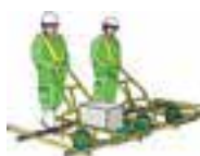
磁気探査概念図
