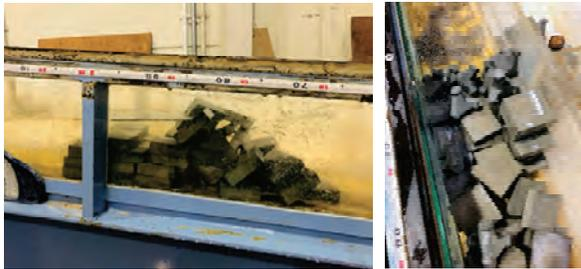
図-8 崩壊状況 (左:ダム E, 右:ダム J)
