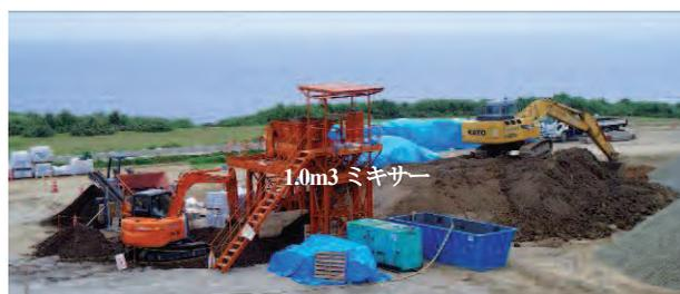
図-3 1.0m<sup>3</sup>の生育基盤製造プラント
