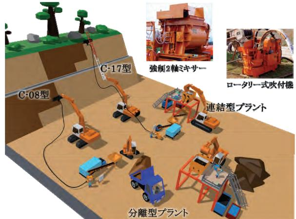
図-12 スロープセイバー概要（植生工）
