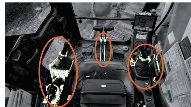
図-19 遠隔操作バックホウの運転席
