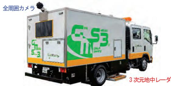
図-2 GMS3 探査車両
