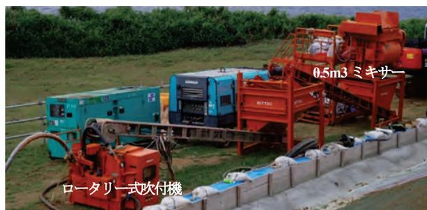
図-2 0.5m<sup>3</sup>の吹付・生育基盤製造プラント
