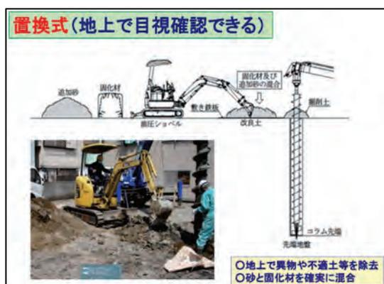
図-5 技術的特徴 (置換方式)
