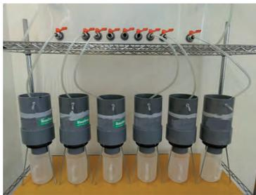
写真-5 ひび割れ透水試験状況
