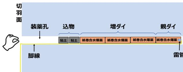
図-1 一般的な装薬の模式図
