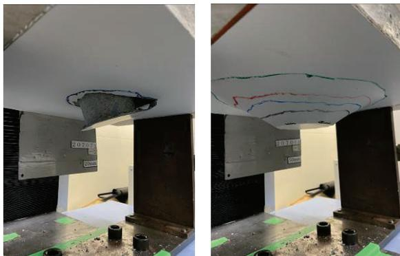
(a)強度不足により破断 (b)最大荷重2 kN
