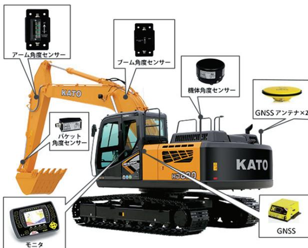
図-1 掘削重機用マシンガイダンスシステム概要<sup>1)</sup>
