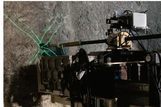
写真-14 レーザーサイトの実装状況
