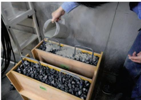
図-1 試験体の製造
