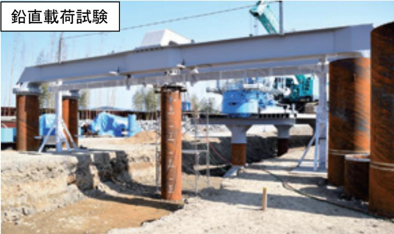
笠付鋼管杭の支持性能を確認するため、笠付鋼管杭と笠のない鋼管杭のそれぞれに対して鉛直および水平載荷試験を実施しました。その結果、笠付鋼管杭は鋼管杭と比較して、鉛直方向で約1.7倍、水平方向で約1.5倍の支持性能を有することが確認されました。
