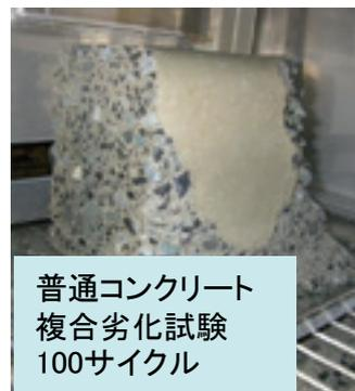
普通コンクリートは微細な空隙が多くあり、浸透した水分が凍結融解を繰り返すことで表面から徐々にひび割れ、劣化が進行します。塩分の影響がある場合はさらに劣化が進行しやすくなります。
