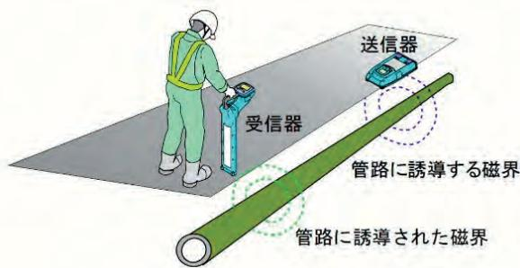
図-14 パイプロケータによる探査
