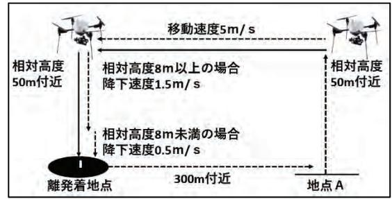
図—10 退避行動の検証（RTL 自律飛行操作）
