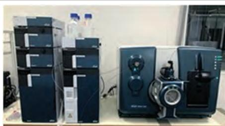
写真 1 LC/MS/MS 装置写真
