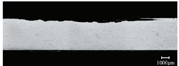
図-14 0.6d 腐食部 マクロ組織写真ノーエッチ倍率×8
