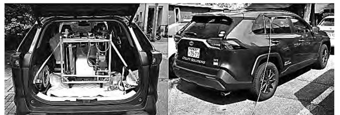
写真-4 車載の様子と車載コンセントからの給電
