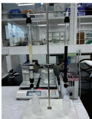
写真3 カラムによる吸着試験状
