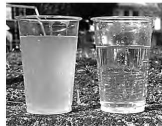
写真-3 ろ過原水(左)とろ過処理水(右)
