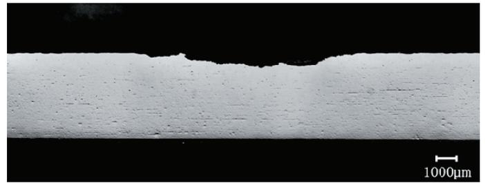
図-13 0.4d 腐食部 マクロ組織写真ノーエッチ倍率×8
