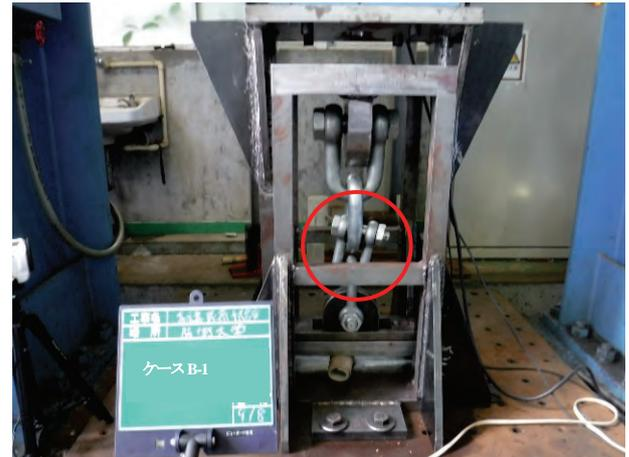
写真-3 供試体の傾き
