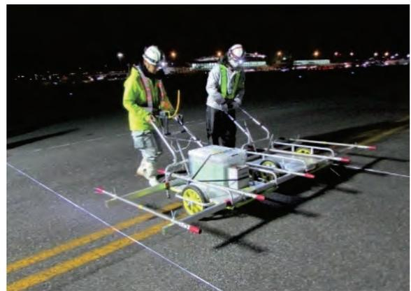
写真-1 5本組センサーによる測定状況
