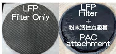
写真-2 フィルター単体（左）と粉末活性炭（黒）を添着したフィルター（右）、実機では円筒状のPleats Filterを使用。
