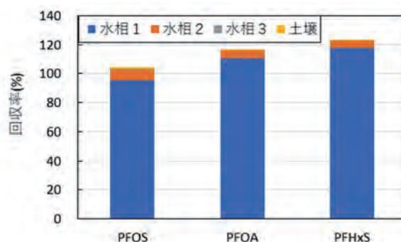
図 7 繰り返し洗浄試験結果(土壌 A)
