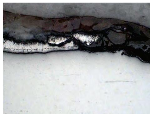
図-16 外面 皮膜の剥がれ 倍率×200
