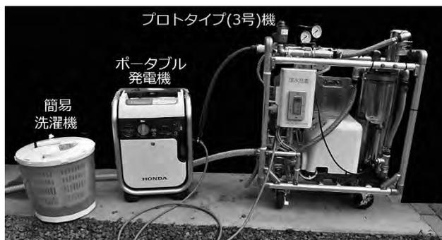
写真-2 プロトタイプ(3号機)と周辺装置の組み合わせ例
