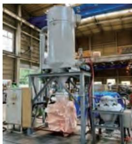
（左）写真—4 ECO クリーン MINI （右）写真—5 FP (Filter Powder) 法 排気処理・脱臭装置。建屋内に置き、屋内空気の循環利用を可能とした
