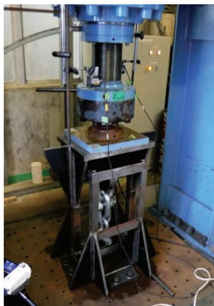
写真-2 高速載荷実験状況
