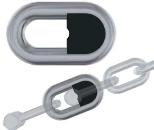
図-1 塑性変形を利用した緩衝機構
