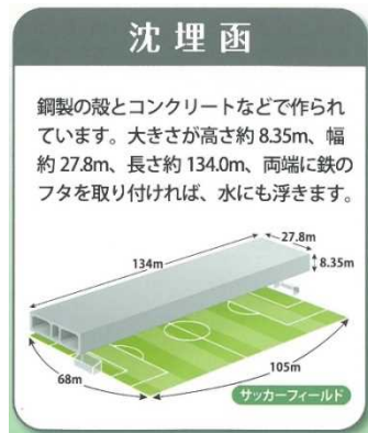
図-3 沈埋函トンネル部の概要
